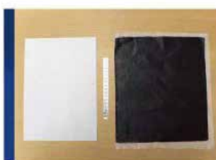
CNTウェブを積層したCNT配列シート。電気・熱・機械特性には大きな異方性があります。結合剤フリーながら、安定自立シートとして容易にハンドリングできます。
